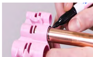
7A. Repérez la profondeur d'insertion sur le tube à l'aide d'une jauge de profondeur
