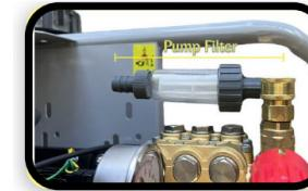
Le filtre de la pompe protège le moteur de la pompe et les autres composants internes des dommages causés par la saleté, le sable ou d'autres particules. Cela permet à la pompe de durer plus longtemps et réduit le risque de dysfonctionnement.
