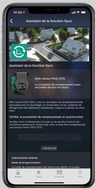
→ La fonction **Sync** est une fonction innovante qui permet de reprogrammer le Wilo-Varios PICO STG pour reproduire les courbes de la pompe Salmson ou Wilo à remplacer. Plus de 30 courbes hydrauliques différentes de pompe sont enregistrées dans le logiciel Varios PICO et la courbe souhaitée peut être sélectionnée sur la pompe via la fonction Sync.
