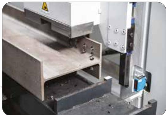
Les lasers sans contact sont utilisés pour détecter l'extrémité de référence de la pièce et sa surface horizontale afin d'établir l'emplacement approprié du trou.
