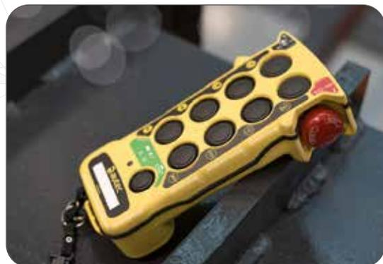
Une télécommande sans fil est intégrée au système, ce qui permet à l'opérateur de participer activement au chargement et au déchargement des pièces tout en garantissant la productivité de la ligne.
