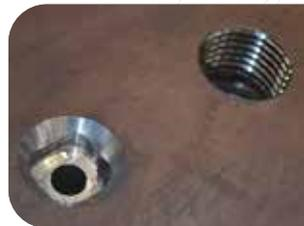
Chanfreinage en forme de « J » pour une bonne interpénétration de la soudure dans les fortes épaisseurs, sans soudure à l'envers
