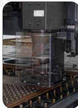
Broche de perçage avec changeur automatique d'outils à 6
