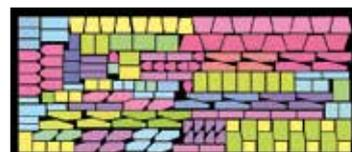
Mise en tôle automatique avec logiciel complet
