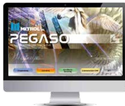
Pegaso est la nouvelle génération de commande numérique pour les machines FICEP. PC industriel, commande numérique et automate sont intégrés sur le même pupitre pour une fiabilité maximum. Pegaso est basée sur la technologie réseau BUS, CanBus et EtherCAT, jusqu'à 32 axes contrôlés.
