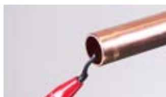
3. Utilisez un ébavureur de type crayon sur les bords internes
